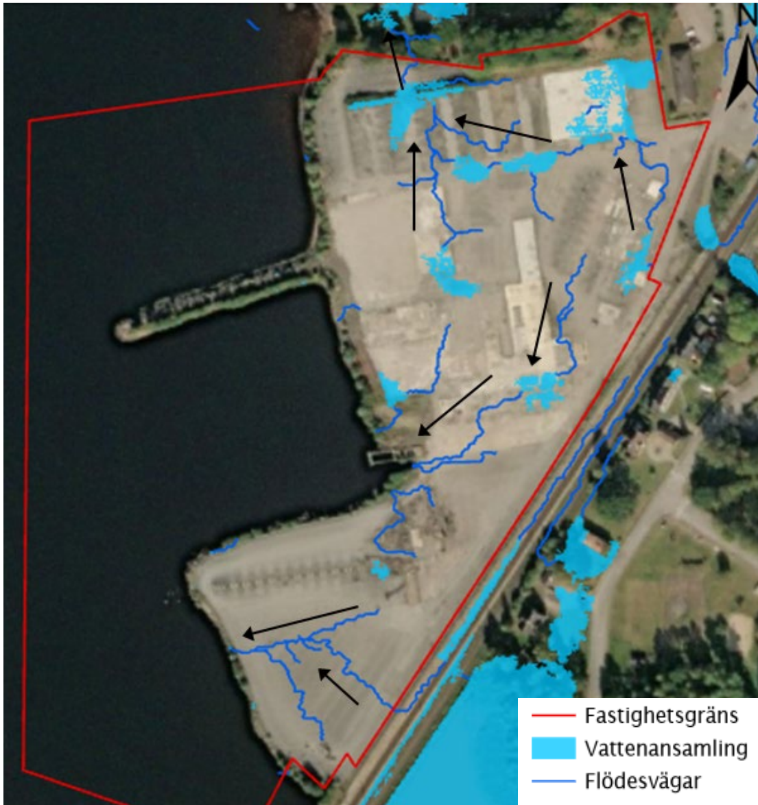
Figur 13 . Flödesvägar (blå linjer) och vattenansamlingar (ljusblå fält) vid skyfall. Svarta pilar visar generell flödesriktning (Tyréns AB, 2021 B).
