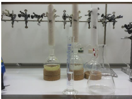
Bild 2: Bild på elueringen, blandningen n-hexan/acetat ”tvättar” ur kolonnerna på fett som hamnar i rundkolvarna.
