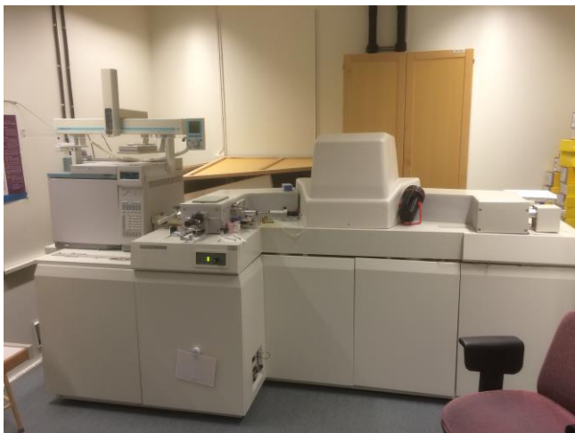
Bild 5: Gaskromatograf-masspektrometern, till vänster är gaskromatografen där de små bägarna placeras, sedan går ämnena genom gaskromatografen till masspektrometern (som är ungefär halva maskinen till höger.)
