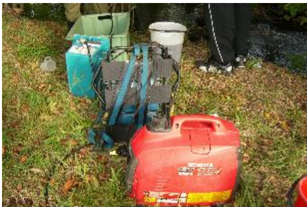
Bild 2. Likriktare (blå) och elverk (röd).
