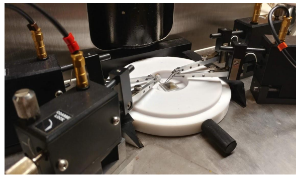
Figur 2: Visar mätmaskinen. Sonderna i Hall-effektmetaren är placerade på elektroderna i varsitt hörn i en grafenbit.
